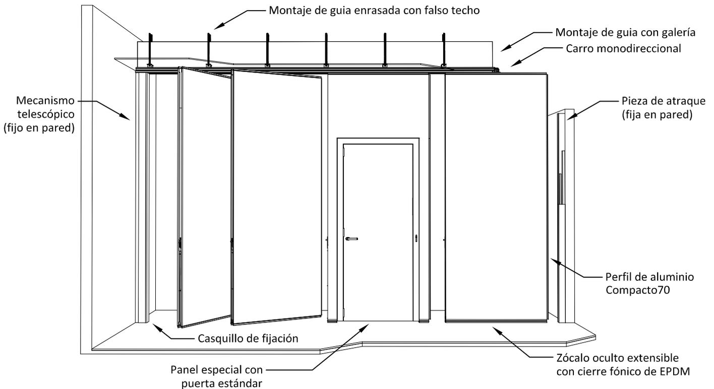
**TABIQUE MÓVIL MODELO COMPACTO70** de Tabimóvil compuestos por paneles sandwich de 70mm de espesor formados por doble tablero de aglomerado o DM de 16mm con cámara. Los módulos se unen entre sí mediante cajeados y perfil macho de aluminio con cepillo que asegura la unión.
