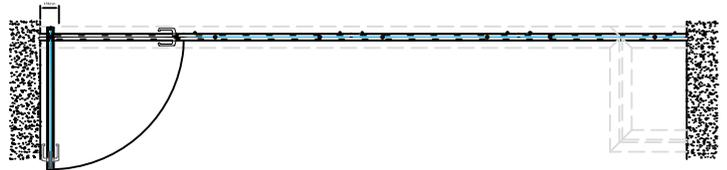
2.- Levantar pasadores (dos por panel). Los paneles abatibles con mecanismos de puerta no llevan pasador a suelo ya que se fijan mediante manivela-cerradero.
