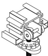
**CARRO MULTIDIRECCIONAL:** formado por dos rodamientos axiales paralelos recubiertos de polímero. Peso máximo soportado 180kg/ud. Se colocan dos carros por panel.
