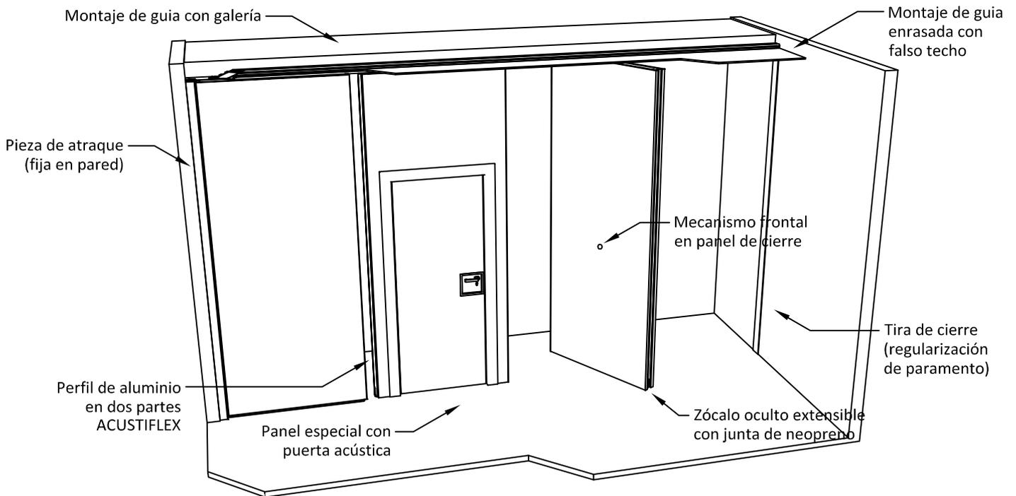
**ACUSTIFLEX 44 dB** de Tabimóvil compuestos por paneles sandwich de 100mm de espesor formados por doble tablero de aglomerado 16mm con lana de roca de 40mm y  $70\text{kg/m}^3$  en la cámara. Los módulos se unen entre sí mediante perfiles de aluminio vistos u ocultos machihembrados con bandas magnéticas y juntas de goma que garantizan la adherencia y aislamiento. Sistemas manual o semiautomático e-Move
